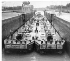
*Le jeudi 26 septembre 1960 passage du 1<sup>er</sup> convoi poussé, en provenance de Dunkerque, dans la nouvelle écluse de Douai longueur totale du convoi 136,80 m, largeur 11,40 m pour un enfoncement moyen de 1,90 m Tonnage total transporté 1470 t*
